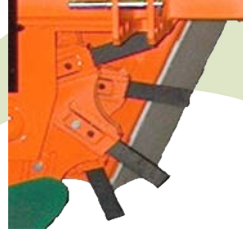
ΣΤΡΟΦΕΙΟ ΠΑΤΕΝΤΑΡΙΣΜΕΝΟ ΜΕ ΥΠΟΔΟΧΕΣ ΓΙΑ ΜΑΧΑΙΡΙΑ ΚΑΙ ΣΤΗΡΙΞΗ ΜΕ ΠΕΙΡΟ ΜΕ ΔΥΝΑΤΟΤΗΤΑ ΜΕΤΑΤΟΠΙΣΗΣ 3 ΦΟΡΕΣ
